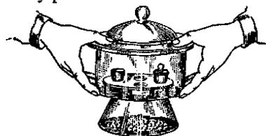
Рис. 8 Эксикатор с фарфоровым вкладышем и тиглями
